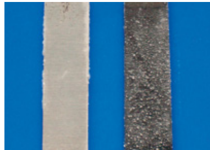
Aluminiumstücke (AA2024) nach 21 Tagen in 0,5 M NaCl-Lösung: a) geschützt durch eine Sol-Gel-Beschichtung mit eingebettetem Inhibitor (links) und b) ohne Inhibitor (rechts).
