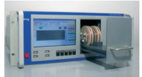
Foto eines ersten Entwurfs eines Fluxgate-MRX-Analyzers.
