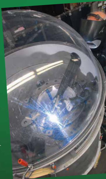
Schweißen eines Titan-Kompensators unter der Vakuumlampe
